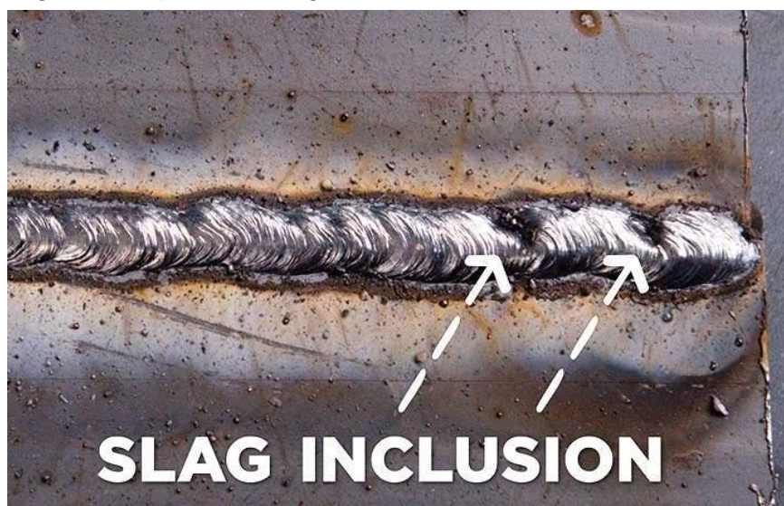
Gambar 3. Defect slag inclusion pada sambungan las
